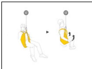
La forma ergonómica del THALES permite a la víctima sentarse en el triángulo y hace que la suspensión sea más cómoda que con un triángulo de evacuación clásico.
