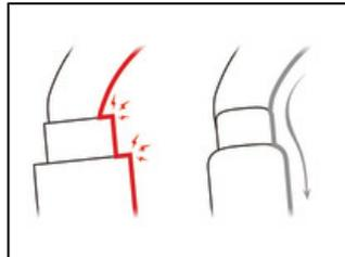
El diseño interior fluido de los mosquetones Sm'D limita el riesgo de punto estable y facilita la rotación del mosquetón.
