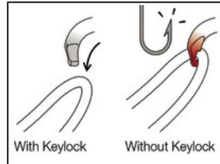
Para garantizar una eficacia óptima durante las maniobras, los mosquetones Sm'D integran el sistema Keylock: sistema de unión del cuerpo y el gatillo sin muesca para evitar que el mosquetón se enganche involuntariamente al anclaje, la cuerda, el anillo portamaterial del arnés...
