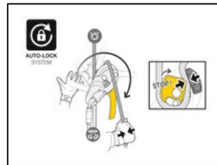
El sistema AUTO-LOCK permite posicionarse fácilmente en el lugar de trabajo, sin tener que manipular la empuñadura ni realizar una llave de bloqueo: desde que el usuario suelta la empuñadura, la cuerda queda automáticamente bloqueada en el aparato.
