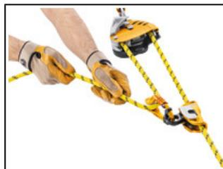
La polea bloqueadora integrada, con roldana de gran diámetro y rodamiento de bolas estanco, dispone de un sentido de rotación único para un excelente rendimiento en el izado.
