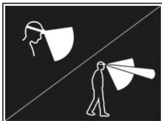
El haz luminoso amplio y homogéneo ofrece una visión confortable para los trabajos de cerca y el haz luminoso mixto permite desplazarse fácilmente.
