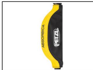
En caso de caída, el desgarro de la cinta del absorbedor de energía limita la fuerza de choque soportada por el usuario. Estos elementos de amarre están destinados a usuarios con un peso comprendido entre 50 y 130 kg. El desgarro de la cinta se realiza por etapas para limitar la desaceleración soportada por los pesos ligeros.
